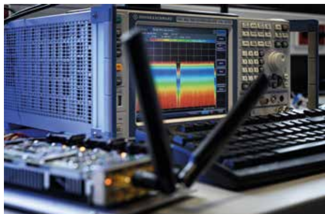
Das Spektrum eines Signals gibt Aufschluss über die Frequenzen, die ein Mobiltelefon zur Kommunikation mit der Basisstation verwendet. Die Forscher ermitteln es mit einem sogenannten Spectrum-Analyzer.
