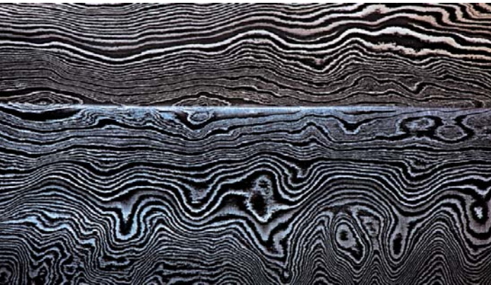
Schon die Schmiede aus Damaskus haben ihre Stähle bearbeitet, um sie zu härten: Sie schmiedeten zum Beispiel verschiedene Stahlgüten zusammen. Beim sogenannten „Damaszener Stahl“ ist diese Struktur aus mehreren, sich abwechselnden Lagen gut zu erkennen.
