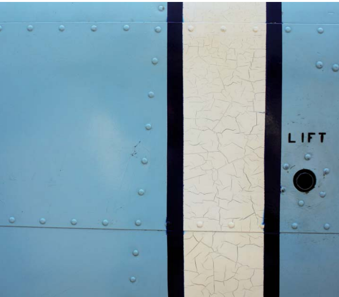
Ein Flugzeug ohne Risse würde nicht fliegen. Deshalb ist es nicht wichtig, Schädigungen komplett zu vermeiden. Es kommt vielmehr darauf an, sie vorherzusagen, mit ihnen zu planen und bereits im Voraus zu wissen, ob sie in einem akzeptablen Maße bleiben.
