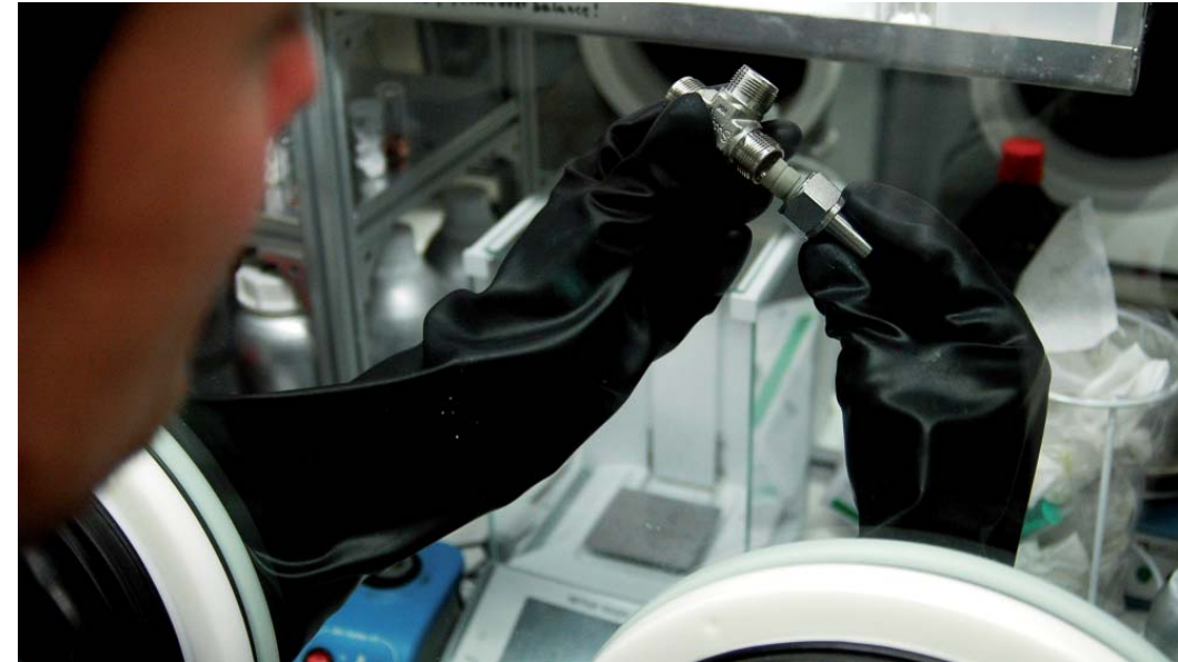
Batteriezellen werden in einer Glovebox zusammengebaut – einem hermetisch von der Umgebung abgeschlossenen Kasten mit definierter Atmosphäre.
